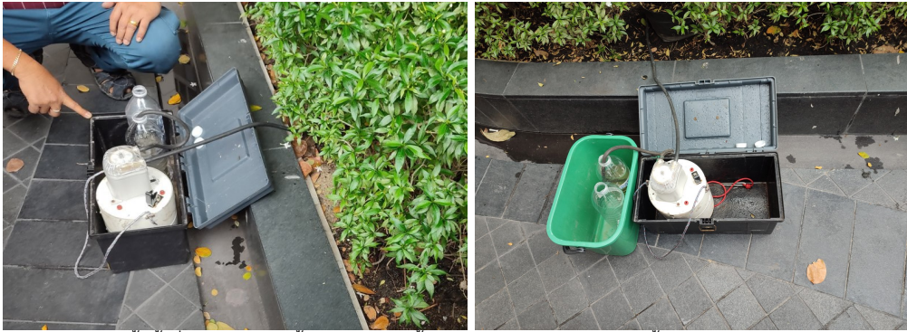
เก็บตัวอย่างน้ำทิ้งที่บ่อปรับสมดุลน้ำเสีย และพักน้ำไหลหลังจากจากระบบบำบัดน้ำเสีย ด้วย Sampling Pump
